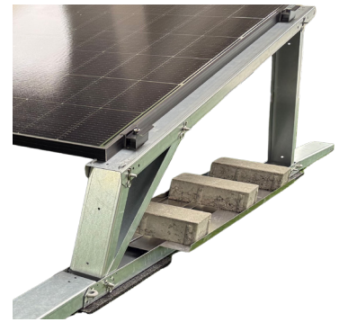
Durchdringungsfreie Montage mit Ballastierung durch Standard-Betonsteine
